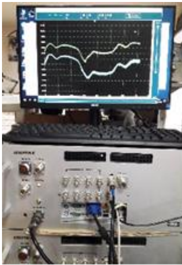
3-сурет – Теттуриялық токтарды тіркеуге және өлшеуге арналған құрылғының прототипінің фотосуреті
